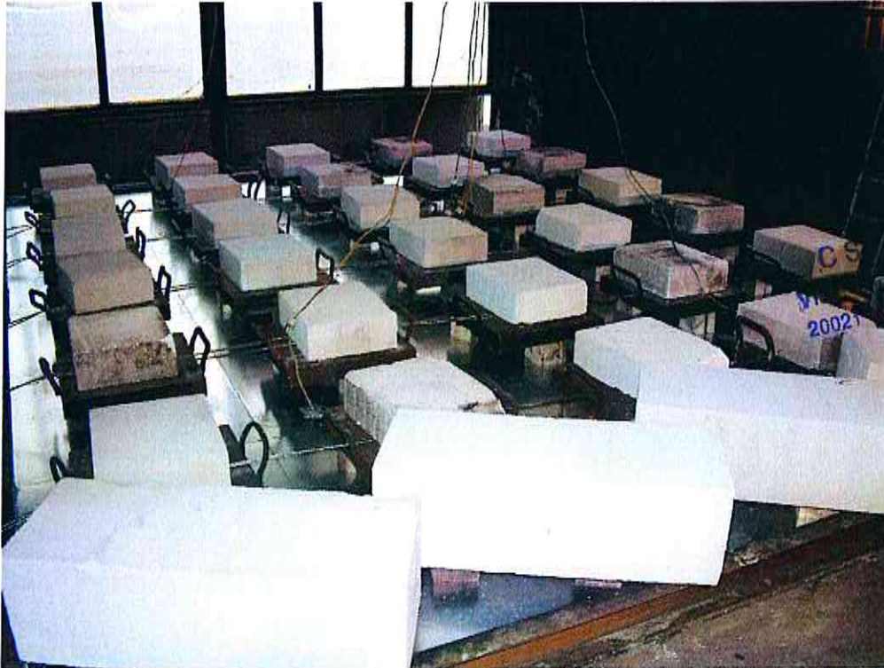
Foto 1. Lato NON esposto al fuoco del manufatto prima della prova
