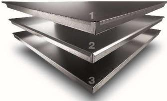
Dalles de faux plancher JVP 4x4 composées d'un cœur en sulfate de calcium avec fibres de papier d'une densité de 1200 kg/m<sup>3</sup>, encapsulées d'une colle à base d'eau dans deux feuilles d'acier galvanisés de 0,40 mm d'épaisseur, recicelées 30% soudées ensemble avec une finition de renforcement périmétrique, breveté, par un renforcement d'un quadruple pli supérieur.
