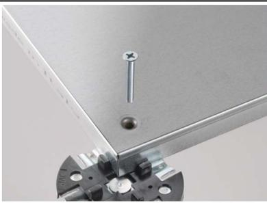
Dalles de faux plancher JVP 4x4 composées d'un cœur en sulfate de calcium avec fibres de papier d'une densité de 1200 kg/m<sup>3</sup>, encapsulées d'une colle à base d'eau dans deux feuilles d'acier galvanisés de 0,40 mm d'épaisseur, recicelées 30% soudées ensemble avec une finition de renforcement périmétrique, breveté, par un renforcement d'un quadruple pli supérieur.
