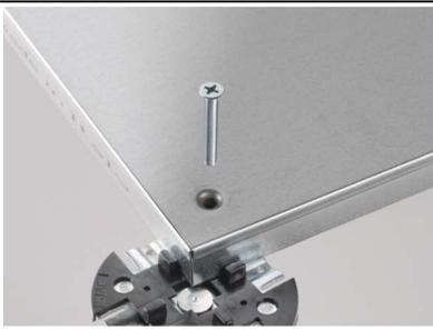
Dalles de faux plancher JVP 4x4 composées d'un cœur en sulfate de calcium avec fibres de papier d'une densité de 1600 kg/m<sup>3</sup>, encapsulées d'une colle à base d'eau dans deux feuilles d'acier galvanisés de 0,40 mm d'épaisseur, recicelées 30% soudées ensemble avec une finition de renforcement périmétrique, breveté, par un renforcement d'un quadruple pli supérieur.
