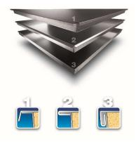
Dalles de faux plancher JVP 4x4 composées d'un cœur en bois particule FSC recyclé 100% d'une densité de 700/750 kg/m3, encapsulées d'une colle à base d'eau dans deux feuilles d'acier galvanisés de 0,35 mm d'épaisseur, recyclé au 30% soudées ensemble avec une finition de renforcement périmétrique, breveté, par un renforcement pli supérieur.
