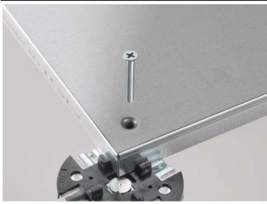
Dalles de faux plancher JVP 4x4 composées d'un cœur en bois particule FSC recyclé 100% d'une densité de 700/750 kg/m<sup>3</sup>, encapsulées d'une colle à base d'eau dans deux feuilles d'acier galvanisés de 0,40 mm d'épaisseur, recyclé au 30% soudées ensemble avec une finition de renforcement périmétrique, breveté, par un renforcement d'un quadruple pli supérieur.
